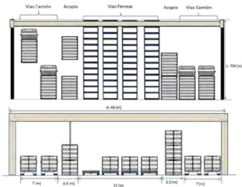
A modo referencial, la **Figura N° 7.16** presenta una sección tipo (en planta y elevación) para el terminal de transferencia, en el que a través del uso de grúas pòrtico es posible lograr alta eficiencia utilizando una franja de ancho acotado (i.e. 14 [m]).
