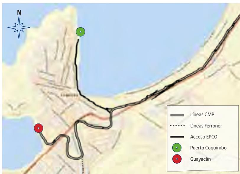
En la **Figura N° 6.4**, es posible distinguir que el trazado de Ferronor (que se extiende entre Iquique y La Calera) y el de CMP (de Romeral a Guayacán), tienen un tramo común de 13 [km] entre Coquimbo y La Serena. Siendo CMP la propietaria de este tramo, la eventual circulación de trenes de Ferronor por esas vías debería hacerse en las condiciones técnicas y económicas que tales empresas acuerden, en el marco de la ley vigente.
