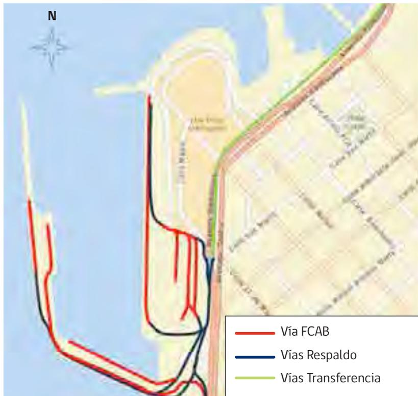
El puerto dispone de una red ferroviaria interna de unos 9 [km] de longitud constituida por numerosos desvíos que permiten acceder a todas las áreas de almacenamiento cubierto y a las áreas de respaldo y transferencias contiguas a los sitios de los dos frentes de atraque. La **Figura N° 5.5** ilustra la disposición de red ferroviaria al interior del recinto portuario.
