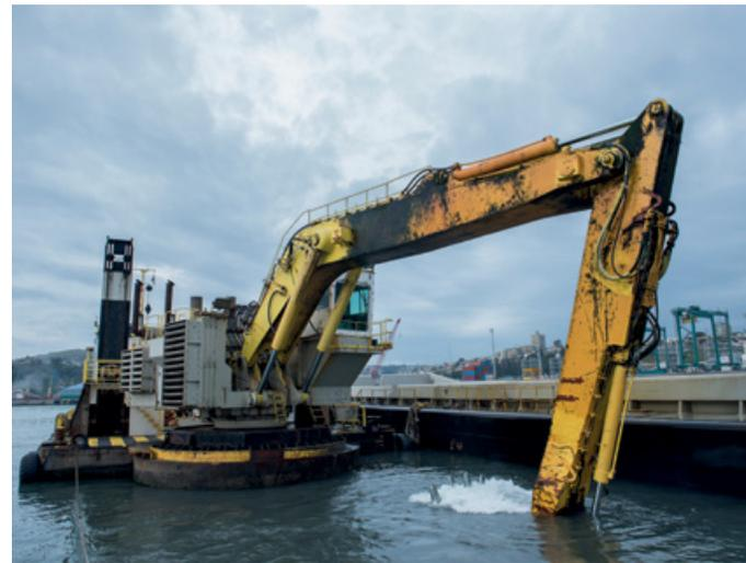
**EL PROYECTO CONSIDERÓ UTILIZAR UNA DRAGA RETROEXCAVADORA (BACKHOE - BHD). EL OBJETIVO DE UTILIZAR ESTE TIPO DE DRAGA ES GARANTIZAR CICLOS DE DRAGADO EFICIENTES.**
