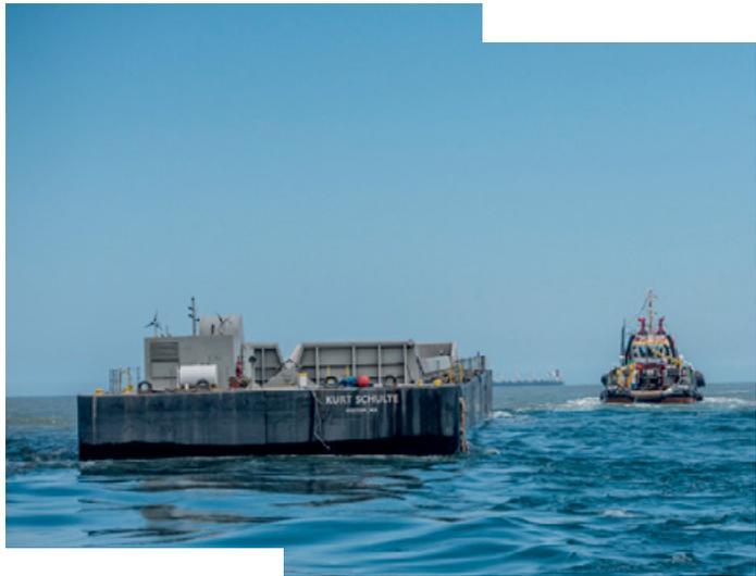
El material retirado se carga directamente a la barcaza emplazada a un costado del pontón, transportando el material excavado a la zona de vertido al momento de llenarse.
