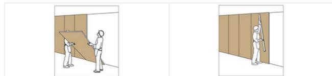
Una vez pegado al muro, se recomienda esperar 24 horas para que el panel Volcapol® Barrera de Vapor reciba el tratamiento de juntas con la Masilla Base JuntaPro Volcán® o el Compuesto para Juntas JuntaPro Volcán®.
