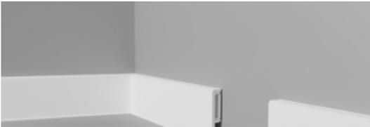
Guardapolvero de PVC Espumado, reemplaza al mdf con mayor resistencia a la humedad, fácil mantención y mayor duración. Tiene fijación oculta con sistema de clips, permitiendo dar espacio para pasar cables de corrientes débiles y por ende registrable.
