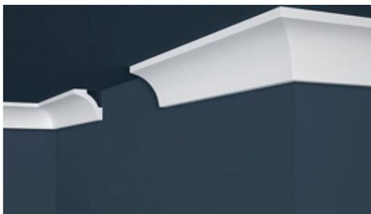
Cornisa de poliestireno extruido (XPS), se utiliza como terminación en las intersecciones entre cielo y muro. Además de ser un elemento decorativo, sirve como solución constructiva la cual esconde imperfecciones y da continuidad para cumplir como terminación sanitaria en cielo. De uso exclusivo en interior, debe ser instalada lejos de fuentes de calor y se debe cubrir con pinturas sin solventes ya que no es resistente a elementos como la bencina, acetona y bencina.
