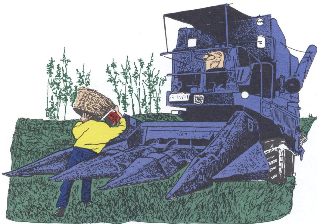
Atrapamiento: Tipo de accidente que se ha venido repitiendo con cierta frecuencia. Se ha originado al vaciar las “mazorcas” en forma manual al depósito de alimentación del equipo.
