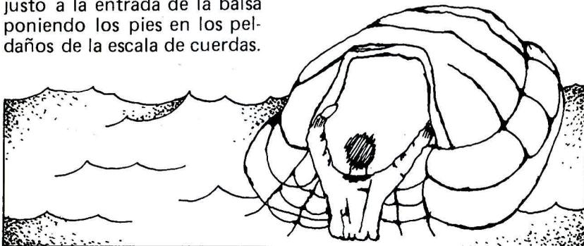
Enderezar la balsa. Hay que evitar que esto suceda, pero si se da vuelta, un hombre la puede enderezar parándose en el cilindro de CO<sub>2</sub>, agarrando el cabo y tirándose hacia atrás.
