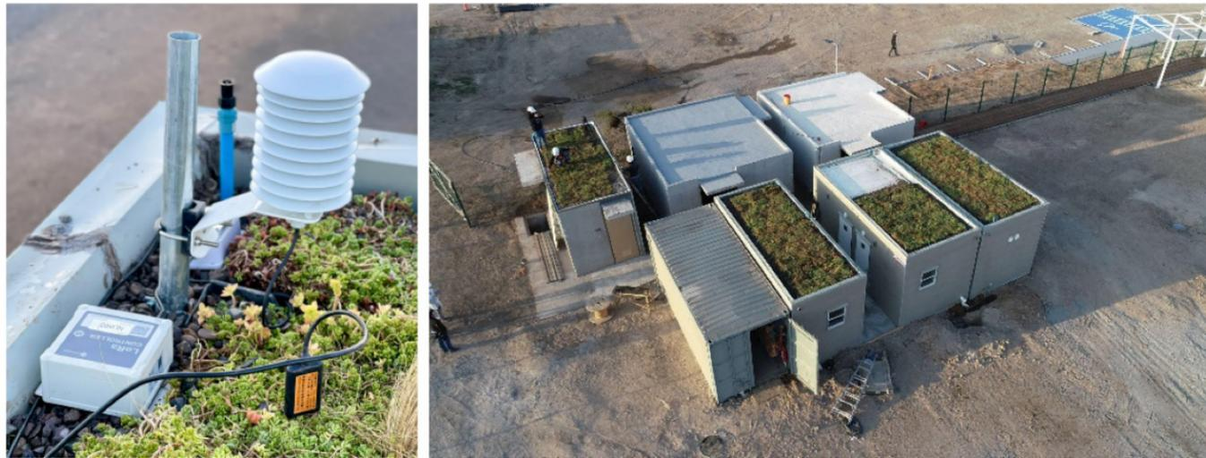
Imagen 7 y 8. Sensores instalados sobre cubiertas VerdeActivo en Parque de Innovación CTeC.
