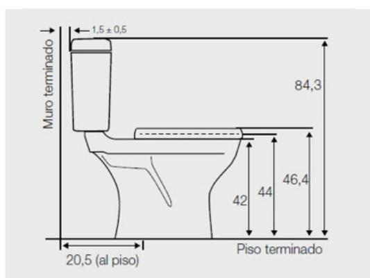
Sistema de descarga de bajo consumo de 4,1 L para desechos líquidos y 6 L para desechos sólidos. Su funcionamiento es por acción directa con efecto de arrastre y anillo abierto con perforaciones de lavado direccionadas con 2 versiones de descarga a piso a 20,5 cm y a muro
