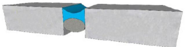
**EJEMPLO 3:** Contracción de los materiales de construcción debido a la temperatura absorbida por los materiales. El resultado es una junta de construcción dilatada.
