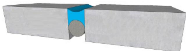
**EJEMPLO 1 SELLADOR APLICADO CORRECTAMENTE:** Sellador de juntas flexible y elástico aplicado correctamente en un soporte con la profundidad y el ancho de instalación correctos.
