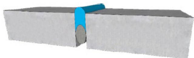
**EJEMPLO 2:** Expansión de los materiales de construcción debido a la temperatura absorbida. El resultado es una junta de construcción comprimida.
