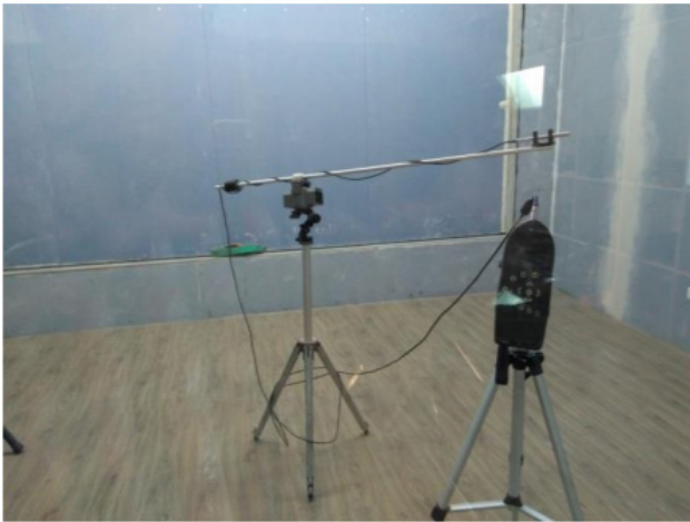
Figura 36: Ensayo NCh 2786 muro divisorio, sala receptora a la izquierda y sala emisora a la derecha. Fuente: CPIA,
