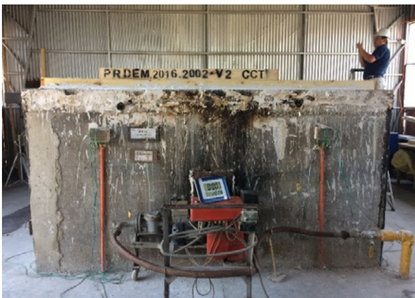
Figura 35: Ensayo NCh 935/1, estructura entrepisos a la izquierda) y muro a la derecha). Fuente: IdiEM, 2018
