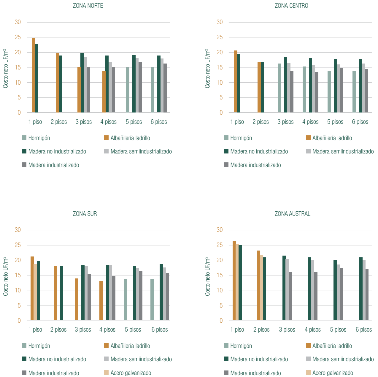
Figura 45: Costos netos (UF/m 2 ) en distintas materialidades y grados de industrialización por zona. Fuente: Elaboración propia, en base a datos de (CIM UC, 2019a).
