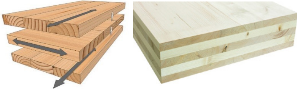
Figura 16: sentido de fibra y en CLT Fuente: (Maderas-uv, n.d.)
