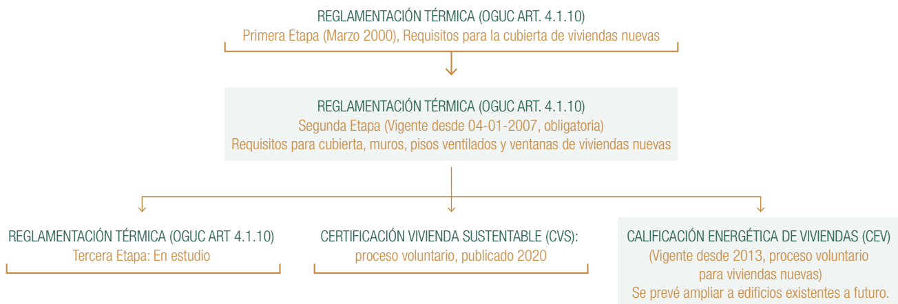
Figura 37: Evolución de la normativa chilena de acondicionamiento térmico de edificios. (elementos en color están vigentes). Fuente: elaboración propia más datos recuperados de EMB Construcción, 2016.
