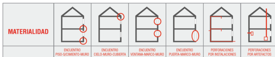
FIGURA 24. ENCUENTROS Y PERFORACIONES DONDE SE PRODUCEN INFILTRACIONES.
