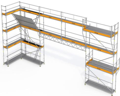
Los elementos del sistema, fabricados en acero galvanizado en caliente, cuentan con un diseño que facilita y mejora las tareas de transporte, armado y almacenamiento. Compuesto fundamentalmente de marcos de 0,70x2,00m, plataformas antideslizantes y junto a los diferentes elementos de seguridad como barandillas, diagonales, rodapiés y otros elementos, forman conjuntos adaptables a diversas geometrías de fachada.
