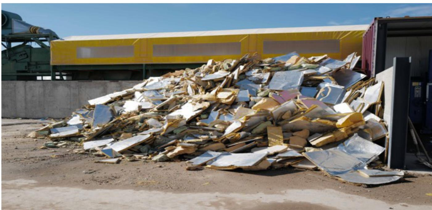
Figura 80: Material aislante, residuos segregados. Centro gestor de residuos de la construcción y demolición “RCD Miajadas”. Gentileza de José Pedro Campos, Instituto de la Construcción.
