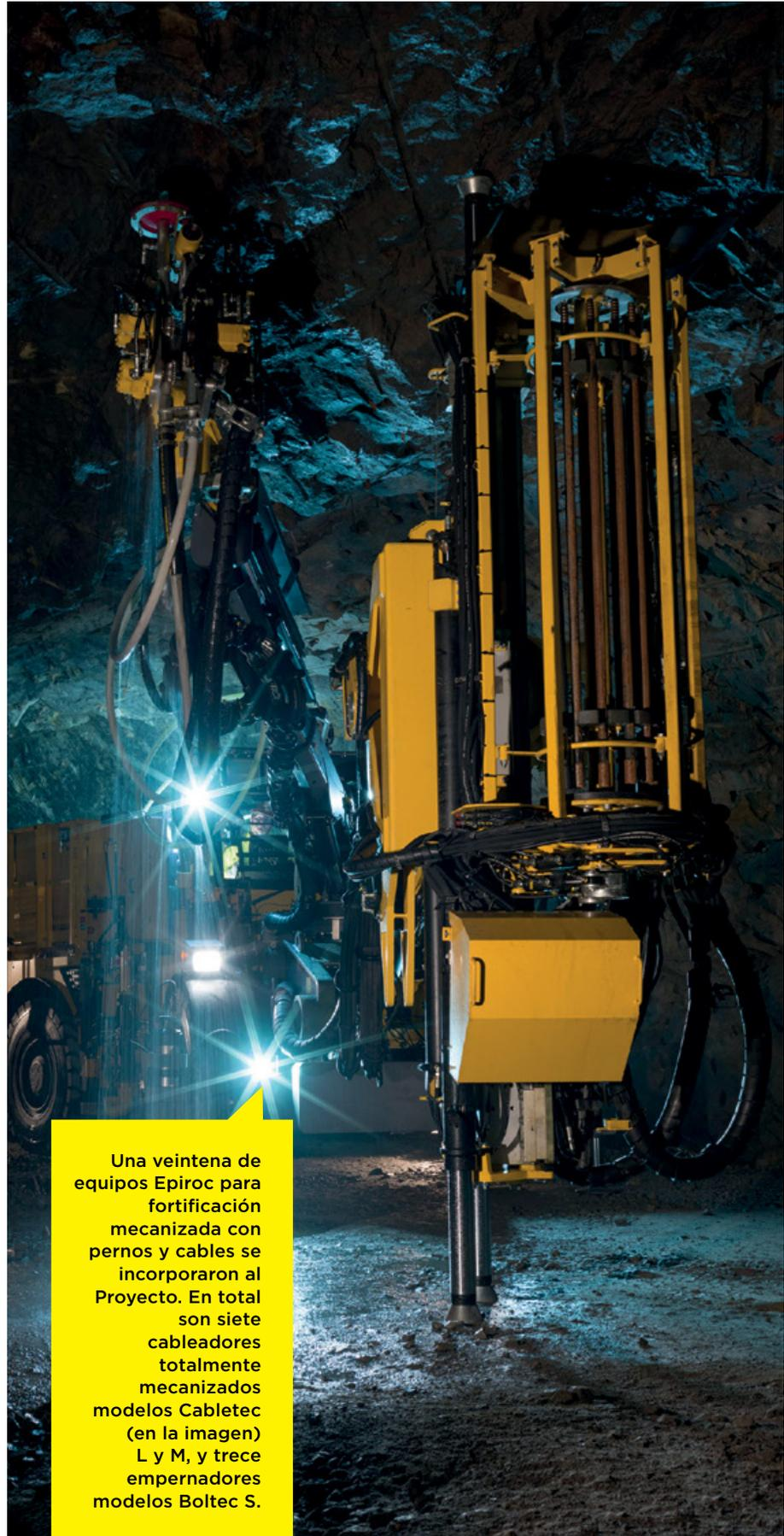
Una veintena de equipos Epiroc para fortificación mecanizada con pernos y cables se incorporaron al Proyecto. En total son siete cableadores totalmente mecanizados modelos Cabletec (en la imagen) L y M, y trece empernadores modelos Boltec S.
