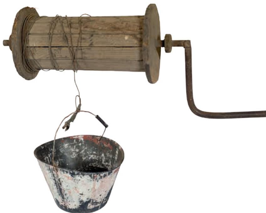
▲ **Torno montado. Usado para extraer tierra cuando se excavaba en profundidad (3 o 4 mts.).**
