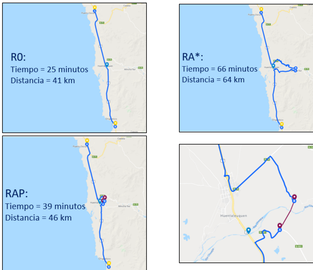
Figura 22. Ruta Alternativa Óptima Puente Choapa
