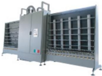
Lavadora de vidrios de 1700mm de altura con 4 cepillos y dos cuchillas de secado.
