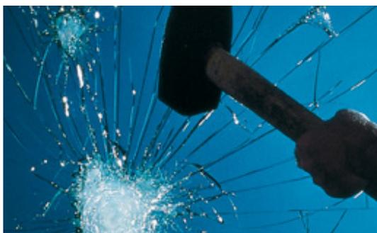
El Cristal Laminado Blindex Seguridad se produce al unir dos o más láminas de Cristal Float con una o más interláminas plásticas de polivinil butiral (PVB), bajo calor y presión.
