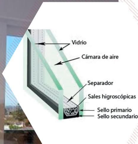
El Doble Vidriado Hermético (DVH) está compuesto por dos vidrios separados entre sí, por un espacio de aire herméticamente sellado para el paso de humedad y el vapor de agua, la cámara cuenta con un perfil separador de contorno doblemente sellado al que se le incorporan sales higroscópicas.
