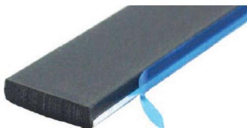
La cinta Separador Flexible Thermoflex Warm Edge reemplaza el uso de los siguientes insumos: separador, esquinero, sales y butilo. Para la fabricación de termopaneles. La cinta contiene el 40% de su peso en sales higroscópicas 3A, que protegen de la humedad a la unidad. Además tiene un pegamento acrílico que junto al corte de esquina con el aplicador hace muy simple el proceso de fabricación. Este Separador requiere que el sello secundario sea de hotmelt. Disponible en colores negro y gris.
