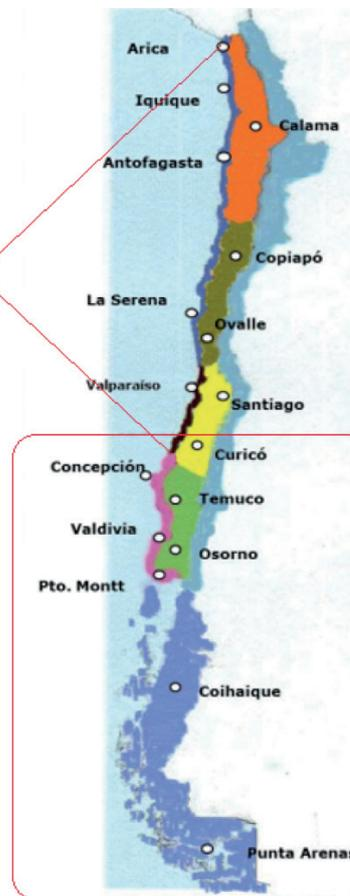
Para **hormigones, estucos de mortero de cemento y ladrillos**, en zonas lluviosas solo utilizar **esmaltes al agua**, según la norma NCh1079 una zona se considera altamente lluviosa a partir de los 600mm anuales, por lo tanto de Curicó al sur.
