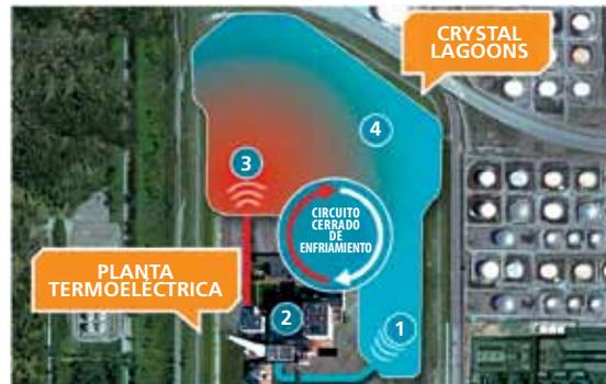
Este sistema permite captar agua de enfriamiento de alta calidad desde la laguna cristalina (1), donde es bombeada hasta la central termoeléctrica para enfriar sus procesos (2). Como resultado de esto, el agua se calienta, aumentando su temperatura (3) y luego se descarga nuevamente en la laguna cristalina de enfriamiento (4). En la laguna se genera la disipación de calor donde el agua fluye hasta alcanzar la temperatura de enfriamiento requerida.
