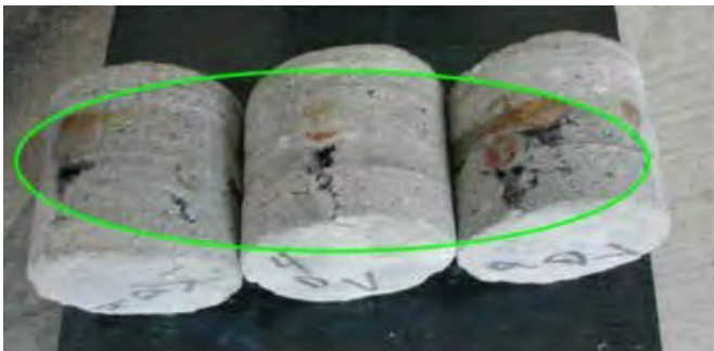
Figura 9.9 Testigos extraídos que muestran el mal encapsulamiento de las barras.
