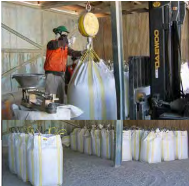
Figura 7.2 Almacenaje de bigbag de shotcrete predosificado.
