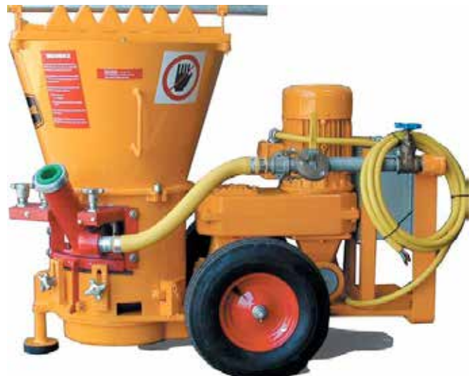
Figura 6.6 Equipo de shotcrete vía seca con "plato rotatorio".
