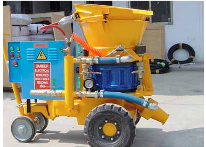
Figura 6.4b Otro modelo de equipo de shotcrete para vía seca del tipo rotatorio.
