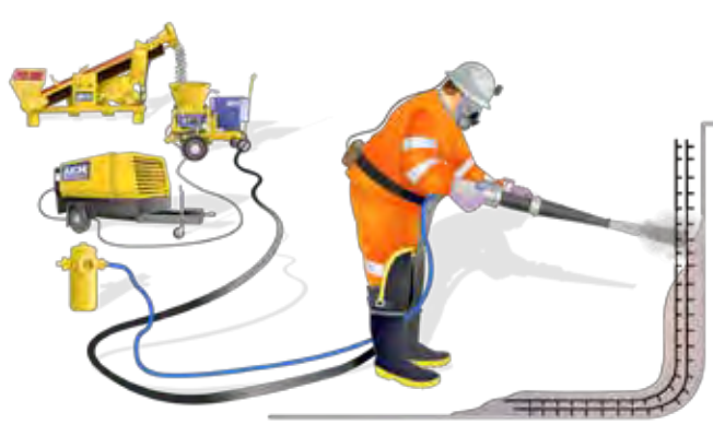
Figura 1.2 Shotcrete por vía seca
