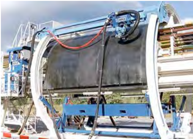
Figura 9.1 Los brazos manipuladores tipo anillo (sobre bastidor de la TBM) son unidades independientes que van montadas en el backup de la TBM.
