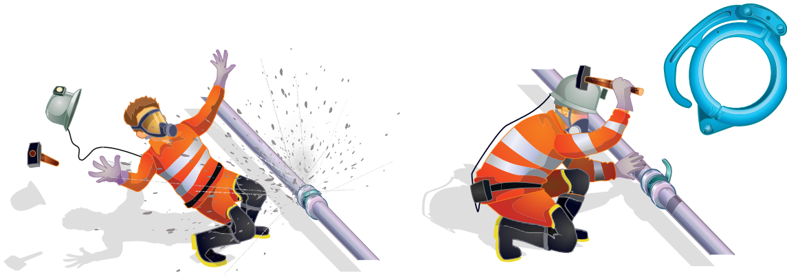
Figura 13.7 El operador debe velar que todas las conexiones de la línea de transporte de hormigón estén debidamente cerradas.
