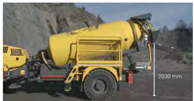
Figura 9.23a Nuevos desarrollos en camión agitador y mixer, con control de descarga remota modelo Mixtec UV2-HD (imagen gentileza AtlasCopco).
