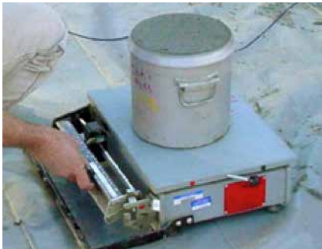
Figura 11.6 Densidad del hormigón fresco.
