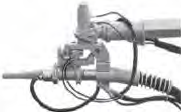
Figura 6.13 Cabezal tipo en un equipo de proyección de hormigón remoto.
