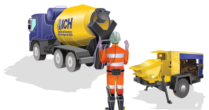
Figura 13.10 En la recepción del hormigón por parte del operador se debe tener en cuenta que debe estar visible durante las labores de retroceso del equipo, hasta su completa detención y nunca ubicarse entre el capacho y el equipo de transporte.
