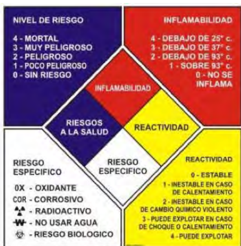
Figura 13.4 Identificación de riesgos de materiales según NCh1411.
