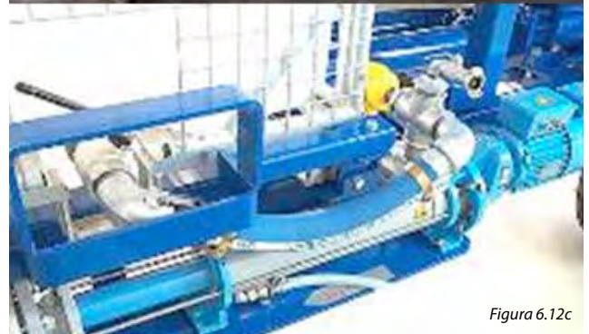
Figura 6.12 Modelos y ubicación de bomba de aditivos del tipo peristáltica y su ubicación en el equipo.
