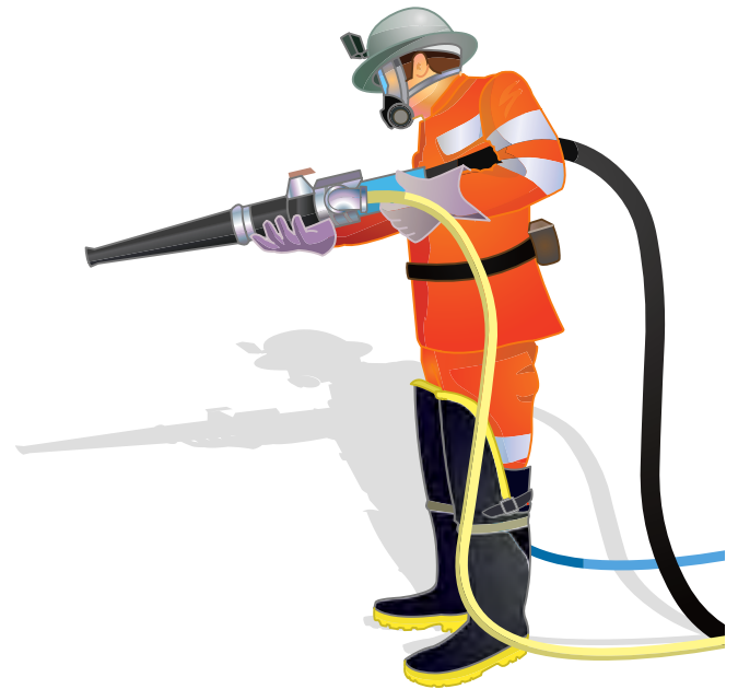
Figura 13.1 Operador con equipo de protección. Equipo de protección personal recomendado para el operador/pitonero de hormigón proyectado. No deben faltar las cintas reflectantes en su vestimenta personal.
