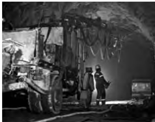
Figura 6.10 Equipo controlado por vía remota para aplicaciones de minería subterránea.
