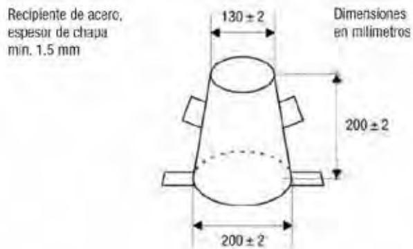
Figura 11.3 Dimensiones del cono para ensayo UNE-EN 12350-5.
