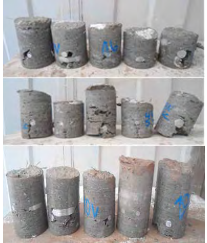
Figura 14.3 Ejemplo de testigos evaluados mediante la distribución de armaduras para un proceso de certificación de pitoneros bajo estar ACI 506.3R.
