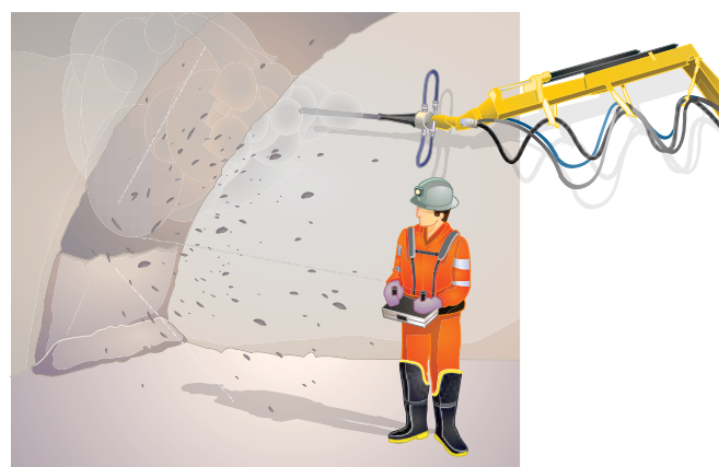
Figura 13.6 Posición del operador durante la proyección. Fuera del área de rebote y con equipo personal adecuado.
