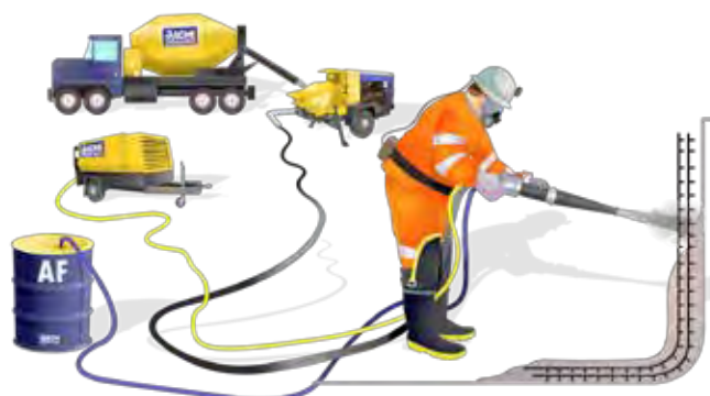
Figura 1.1 Shotcrete por vía húmeda
