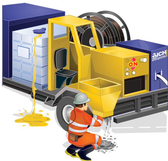
Figura 13.11 Todas las operaciones de limpieza de los equipos deben ser realizadas con equipos completamente apagados y sin conexión eléctrica.
