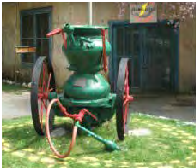
Figura 1.17 Antiguo equipo de shotcrete, antiguas instalaciones de la División El Teniente de CODELCO en Coya.
