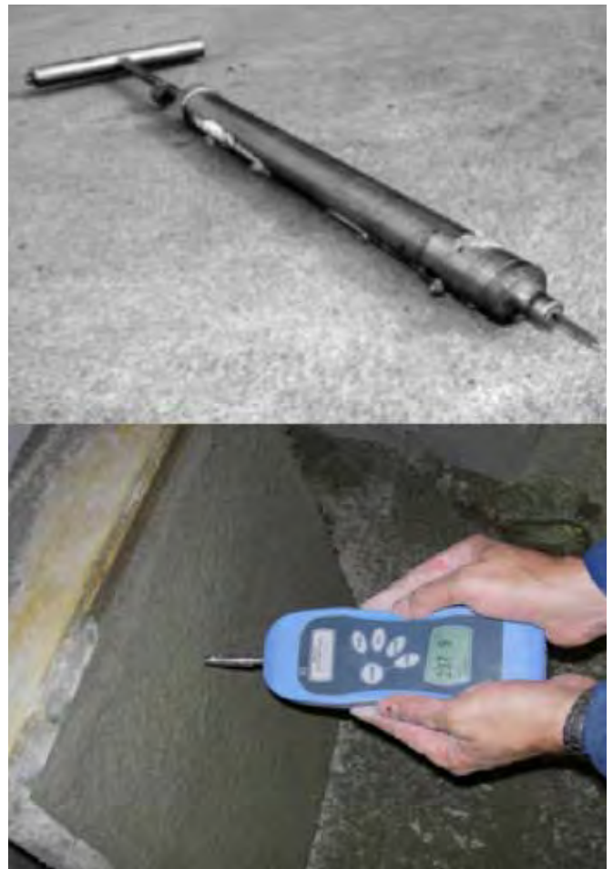
Figura 11.9 Modelos de penetrómetro tradicional para hormigón y uno más moderno con lectura digital. En ambos casos el principio de lectura es el mismo, así como la necesidad de calibración.
