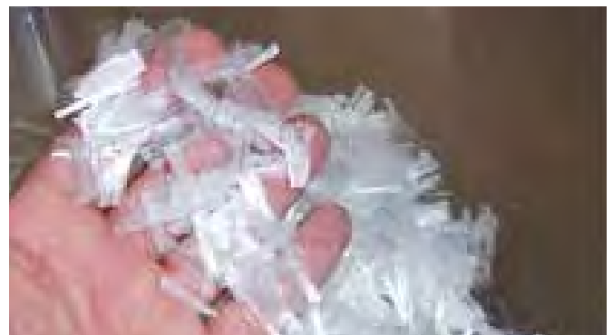
Figura 4.4 Micro fibras sintéticas (de especial uso en Shotcrete para la protección de incendios).
