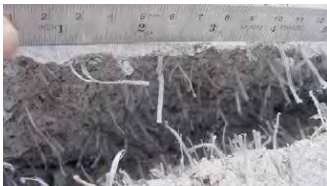
Figura 2.6 Distribución de la fibra en la matriz de hormigón (imagen gentileza GRACE, B. Vicencio)
