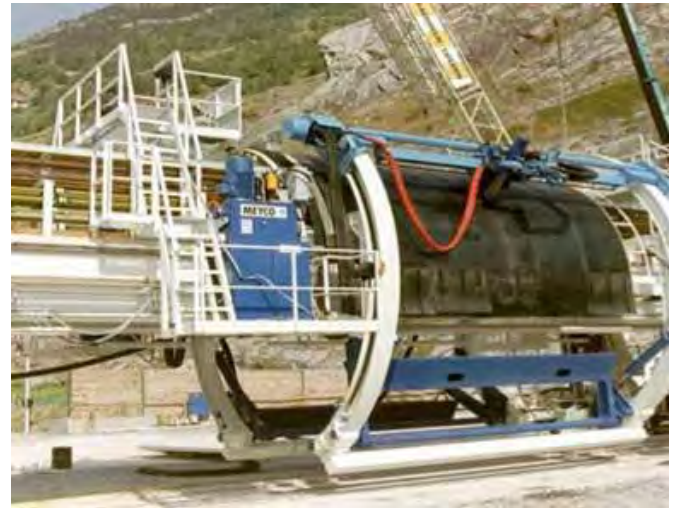
Figura 9.31 Brazo para aplicación de shotcrete montado en una TBM.
