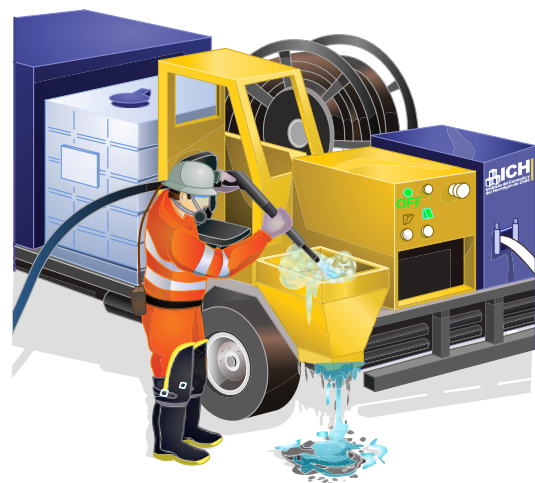
Figura 13.11 Todas las operaciones de limpieza de los equipos deben ser realizadas con equipos completamente apagados y sin conexión eléctrica.
