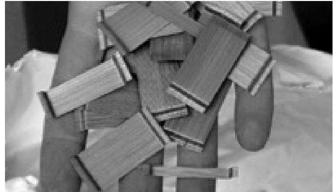
Figura 4.1 Es una tendencia en algunos fabricantes, la entrega de fibras de acero con extremo de gancho pegadas entre sí cuando se envasa para reducir la tendencia a la formación de bolas en el interior de la mezcla de hormigón.
