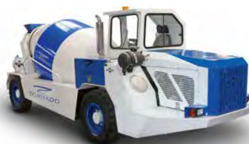
Figura 8.2 Camión transportador "mezclador", ambos de bajo perfil para obras subterráneas.
