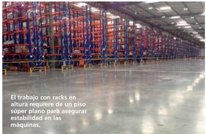
El trabajo con racks en altura requiere de un piso súper plano para asegurar estabilidad en las máquinas.
