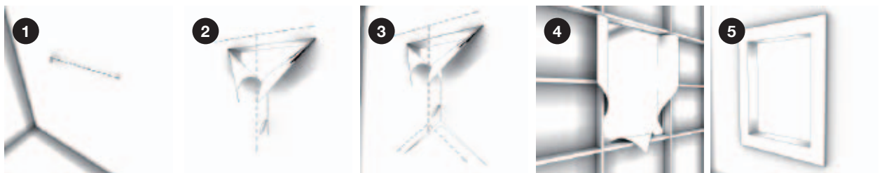
Figura 5.27. Procedimiento de instalación de ventanas y puertas después de aplicada barrera de humedad.
