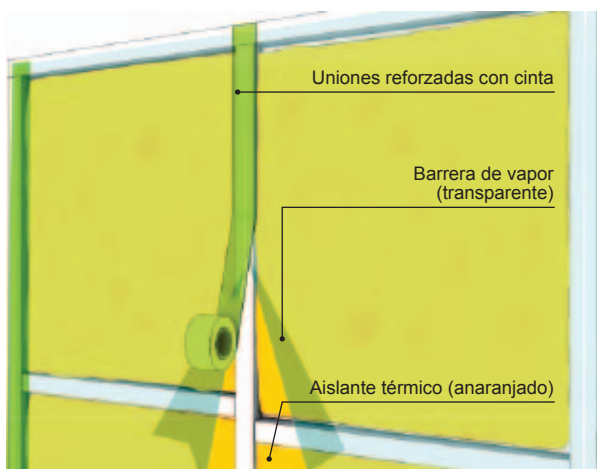
Figura 5.25. Sellado de la barrera de vapor con cinta especial.
