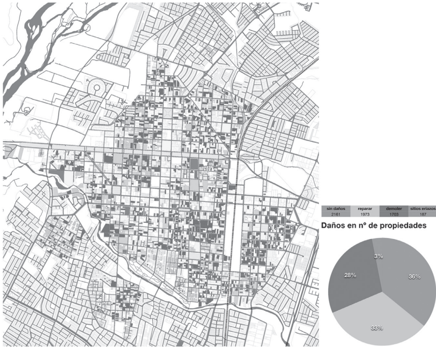
Imagen 1: Plano centro de Talca que refleja daños
