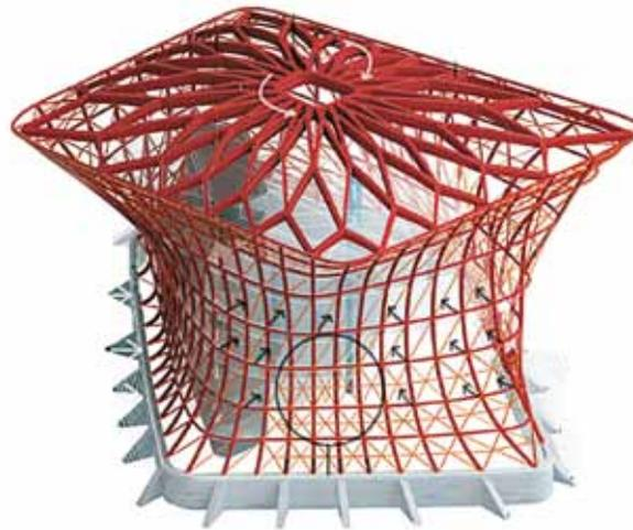
El eje de la estructura se comprime mediante una torsión que, provoca que el edificio posea diferentes ángulos de inclinación que proporcionan sombras en grandes secciones de la fachada.
