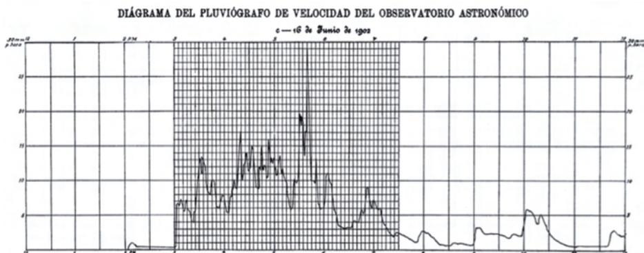
Ejemplo del registro de precipitaciones del pluviógrafo de velocidad del observatorio astronómico, en Van Broekman G., *Breve..., op. cit.*, lámina III.
