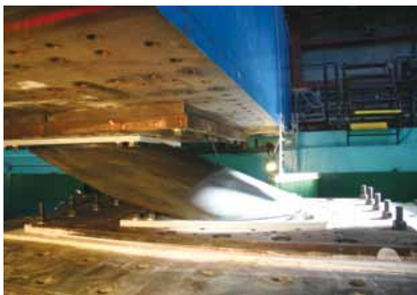
Figura 44. Ensayo de aislador elastomérico. DIS (EEUU)
