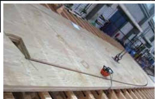
Las formas curvas de la madera, extraídas de grandes placas rectangulares y compuestas por finas láminas, fueron cortadas por un robot controlado electrónicamente y programado para optimizar el proceso de corte y minimizar la pérdida de material.
