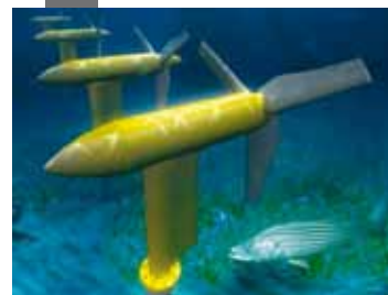
Modelo de turbina que aprovecha la energía marina.
