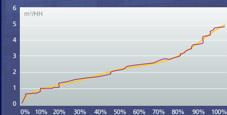
PARTIDA MOLDAJE RENDIMIENTO COLOCACIÓN MUROS
