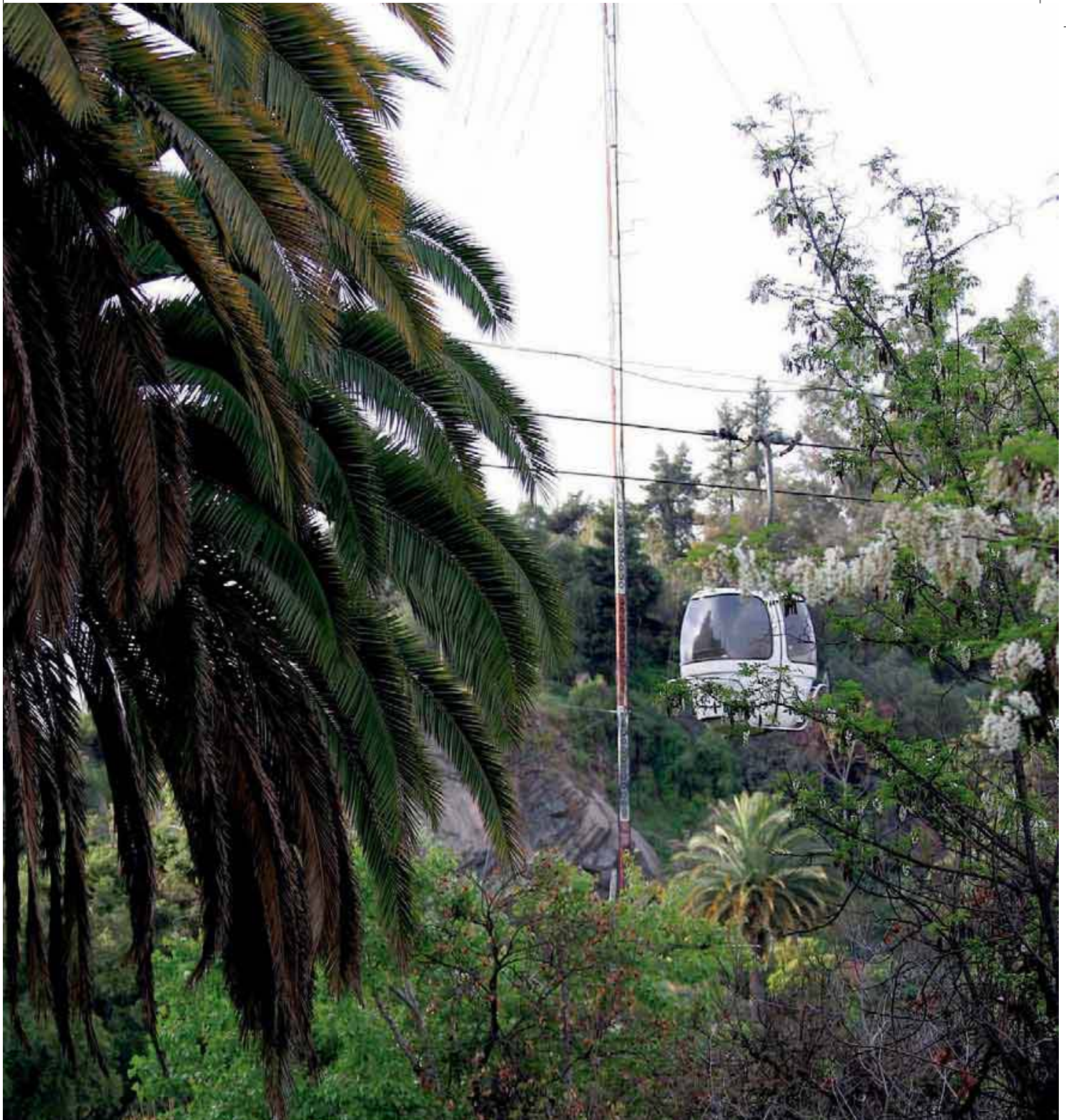
En 1980 comenzó a operar el teleférico, conformado por 72 cabinas de acrílico que recorren más de cuatro kilómetros (trayecto de ida y vuelta) a una velocidad promedio de 14 kilómetros por hora, con una altura máxima de 38 metros.
