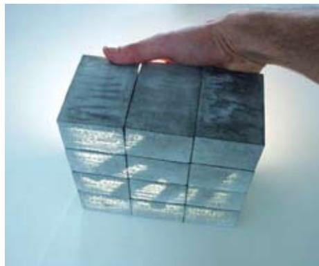
Un material innovador en este segmento consiste en bloques de fibra óptica y hormigón que otorgan propiedades traslúcidas.
