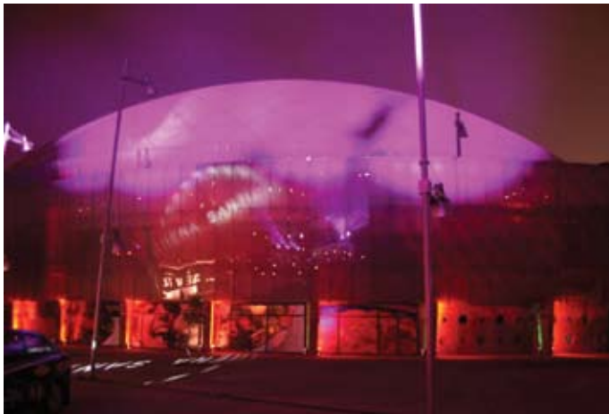
Direccionando la luz hacia arriba, los focos ubicados en el borde de la cúpula aprovechan la superficie reflectante potenciando la altura del edificio. (Foto der.) En el exterior un sistema de iluminación especial permite reflejar mensajes sobre la cúpula. (Foto izq.)
