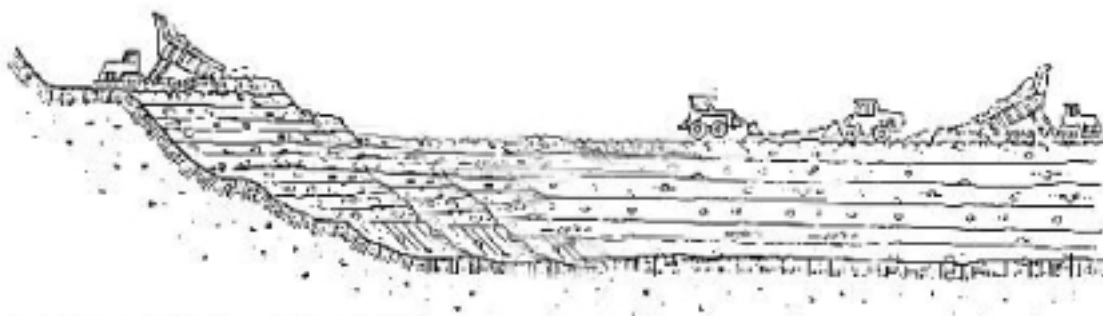
Vertido extendido, relleno y compactación con bulldozer
