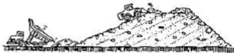
Elevación y extendido con bulldozer
