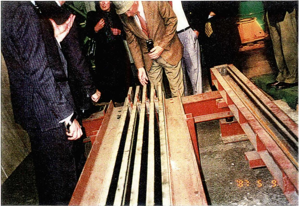
SISTEMA PREFABRIC PLACAS (VIBRADAS)
