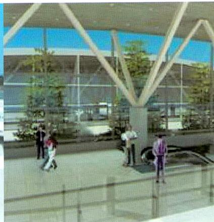
**Generalidades:** Ventilación transversal, patio central con vegetación para estimular estabilización climática, humidificación y convección térmica, agregando oxígeno y consumiendo CO2 del ambiente interior, ventilación e iluminación natural.
