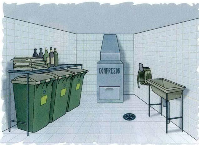
La sala de basura tiene al menos un punto de agua con una válvula y conexión para manguera.
