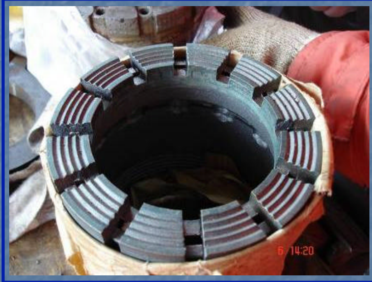
CORONA GEOBOR Perforación F 150mm
