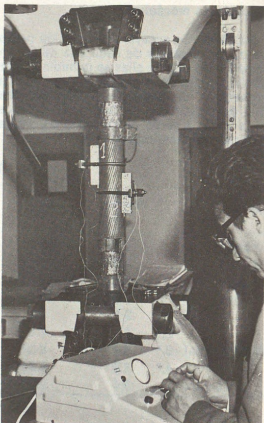
Fig. 4. Trozo de cable en la máquina de tracción. Se observan los extensómetros a cuerdas vibrantes.
