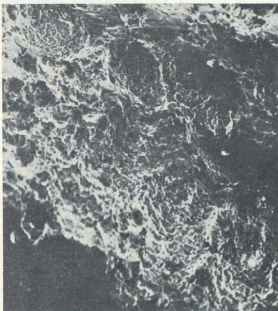
Fig. 10 Aspecto de la rotura de una hebra del núcleo central. 500 x.
