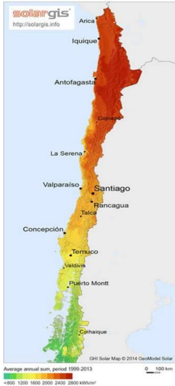
Figura 1: Suma anual de capacidad de generación en Chile (kWh/m 2 )
