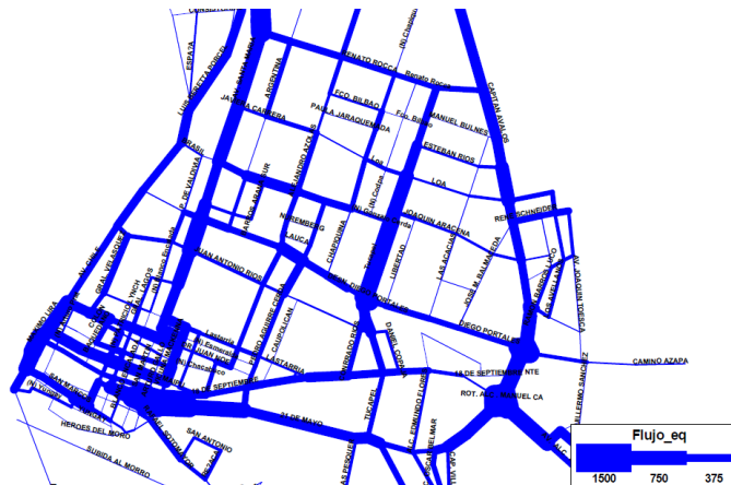
Figura N°29 Simulación Flujos Área Central, 2005
