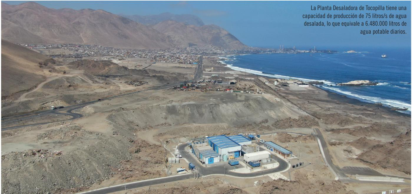
La Planta Desaladora de Tocopilla tiene una capacidad de producción de 75 litros/s de agua desalada, lo que equivale a 6.480.000 litros de agua potable diarios.
