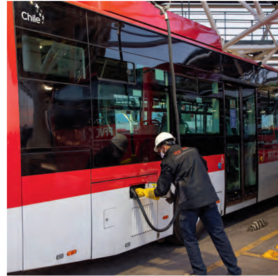
Un sistema retráctil acciona el cable del cargador para que descienda al bus y luego suba hacia la máquina cargadora.
