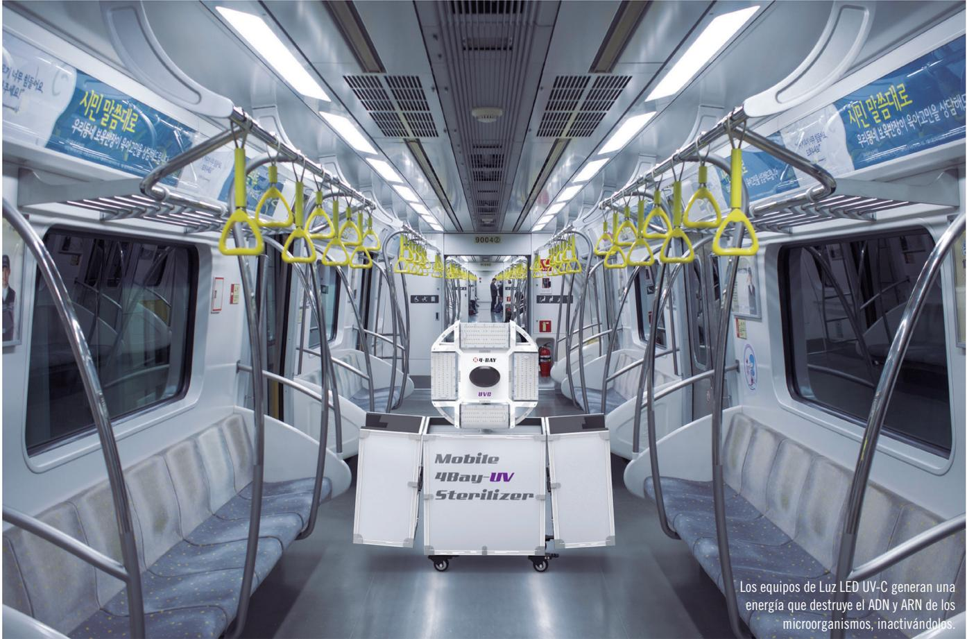
Los equipos de Luz LED UV-C generan una energía que destruye el ADN y ARN de los microorganismos, inactivándolos.
