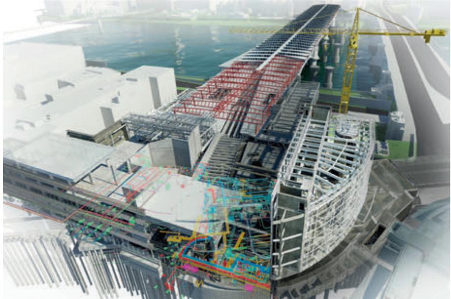
BIM permite que cualquier interferencia en el diseño de un edificio aparezca en una etapa temprana.
