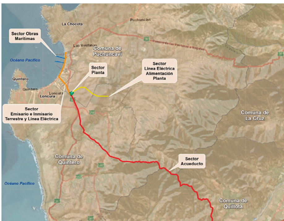
Las instalaciones contarán con un acueducto de 30 kilómetros.
