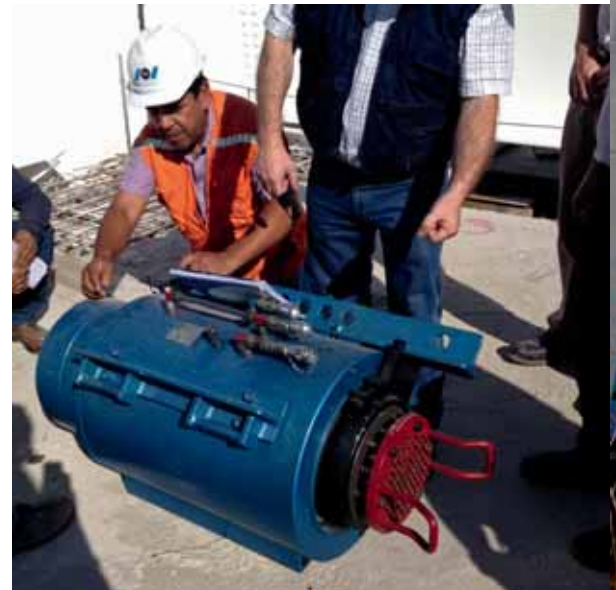
Arriba: izquierda, Leopoldo Breschi, socio de VMB Ingeniería Estructural. Derecha, Estructura metálica de soportación temporal. Abajo: izquierda, Demolición de columnas de traspaso de cargas. Derecha, Cilindro hidráulico para tensado de multitorones. Fotos: VMB.
