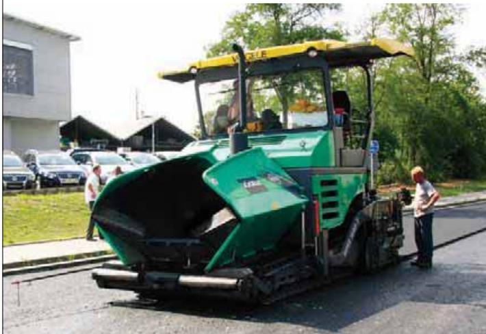
Nada se compara a la calidad y tecnología alemana de una pavimentadora Vögele Super 1600-2. Con anchos de extendido de hasta 8 metros, rendimiento de hasta 600 toneladas por hora, un potente motor Perkins de 100 kW, gestión electrónica de propulsión constante y el innovador sistema de mando ErgoPlus, Vögele Super 1600-2 la pavimentadora profesional perfecta para obras medianas y grandes.
