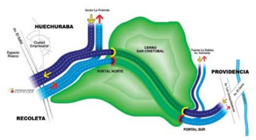
Dos grandes túneles paralelos de 1,8 kilómetros unirán en sólo tres minutos los extremos norte y oriente de Santiago. En su interior, los ductos estarán conectados por medio de ocho galerías de evacuación, siete peatonales y una vehicular.
