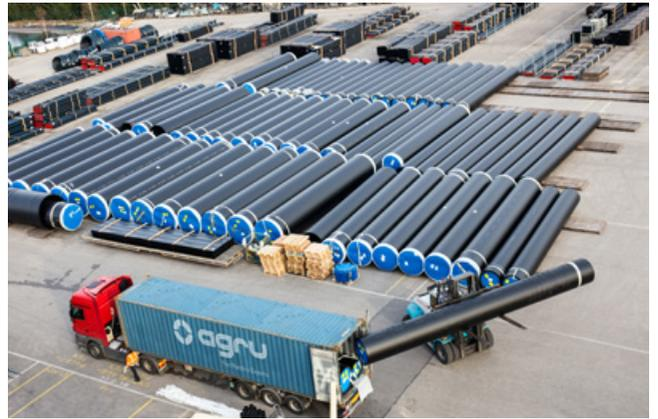
Debido a que las tuberías de HDPE están en la clase de peso pluma en comparación con las tuberías de acero o de hormigón, y con una densidad de solo 0,95 kg / dm<sup>3</sup>, podrían flotar en el agua sin ayuda. Esta característica permitiría una forma de entrega única: “Remolcar tiras de tubería fabricadas a pedido sobre el océano en las dimensiones requeridas hasta los sitios de operación marinos, es la forma de transporte más eficaz y económica”, comentan desde la empresa.
