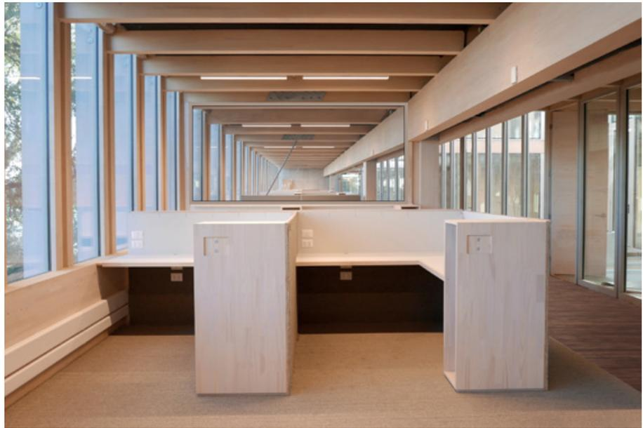
La arquitectura interior incluyó el diseño de muebles de estaciones de trabajo, cuya altura es la justa que permite despejar el horizonte visual de la persona sentada. Tanto estos paneles como los pisos de las naves donde se ubican, están cubiertos de alfombra que funcionan como absorbente acústico complementario a la lana absorbente colocada sobre los serpentines de climatización a la vista en los cielos entre el envigado estructural.
