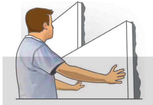
Pegado de planchas sobre el muro de forma trabada.
